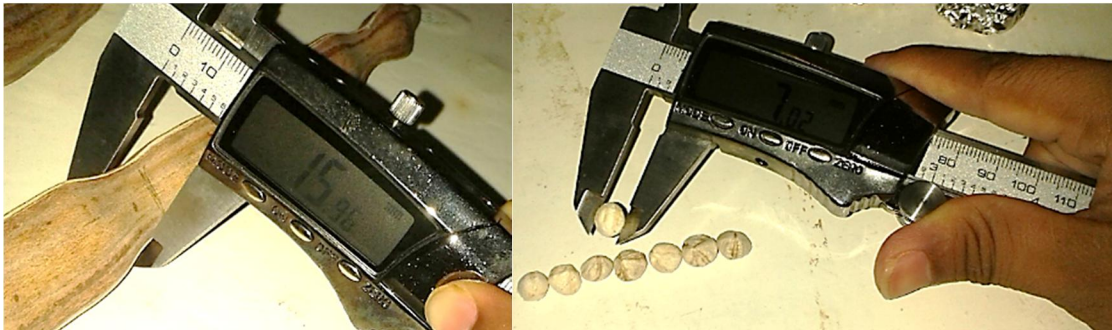
Fig. 4 Dimensiones lineales de la vaina y almendra de moringa.
