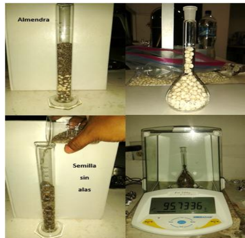
Fig. 5 Determinación de densidad aparente y a granel
