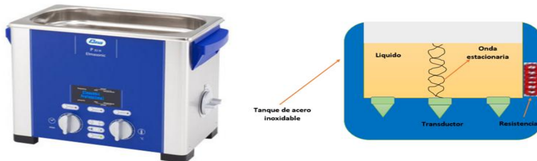
Fig. 2 Imagen y esquema de un baño ultrasónico
